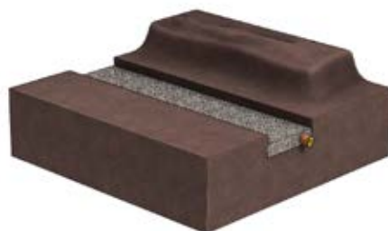
Vul de sleuf met gebroken grind Remplissage de la tranchée avec du concassé de petit calibre
