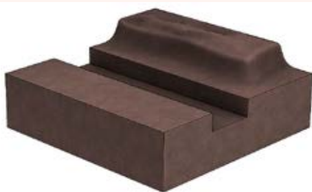
Voorbereiding fundering afmetingen 60 x 30 cm Préparation de la fondation : dimensions 60 x 30 cm
