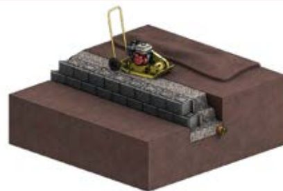
Plaats de tweede rij blokken, vul split aan in en achter de blokken en verdicht Pose de la deuxième rangée de blocs, remplissage à l'intérieur et derrière les blocs et compactage
